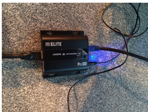
Système de liaison entre l'ordinateur et le projecteur
